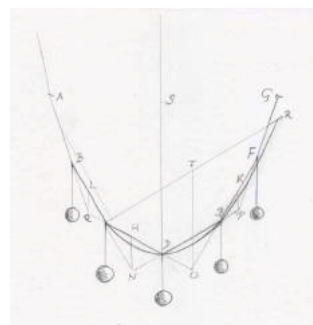
Hängemodell, Zeichnung nach einer Zeichnung eines Hängemodells (Kettenlinie) von Christiaan Huygens, 2017
